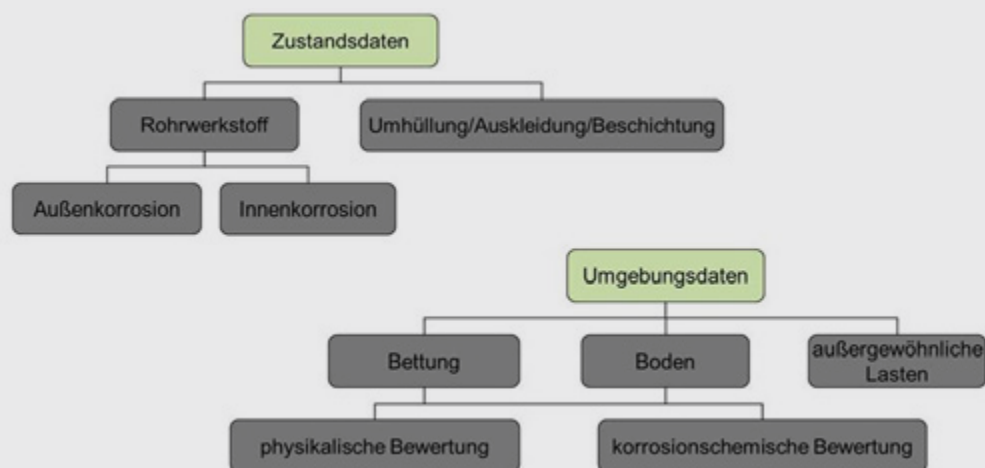
Bild 11: Zu erfassende Umgebungs- und Zustandsdaten nach DVGW-Merkblatt GW 19-1 [6]
