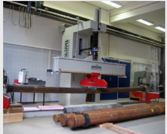
Bild 4: Biegeversuche im Testportal der Firma FORM+TEST
