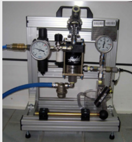
Bild 7: Zur Versuchsdurchführung benutzter Druckübersetzer der Fa. Haskel
