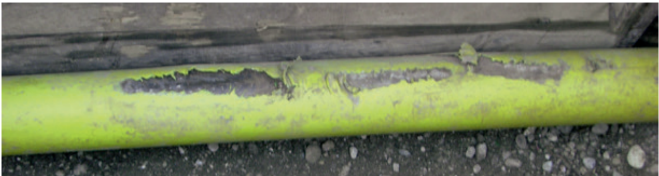
Abb. 1: Baggerzahnangriff – Schadensbild einer Stahlrohrleitung
