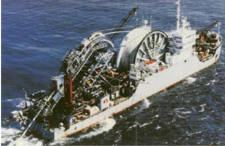
Bild 7: „Reeling“ von Leitungen in der Off-Shore-verlegung
