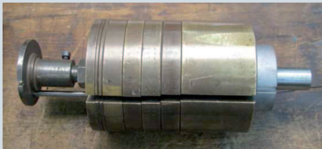
BILD 4: Fallgewicht für den modifizierte Schlagversuch
