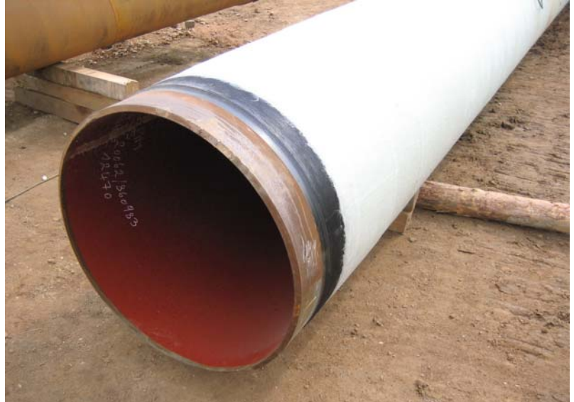
Bild 10. PE-Werksumhüllung mit zusätzlicher GfK-Umhüllung.
