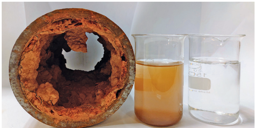
Abb. 1: Korrosionsschaden mit Beeinträchtigung der Wasserbeschaffenheit und der Hydraulik der Rohrleitung
