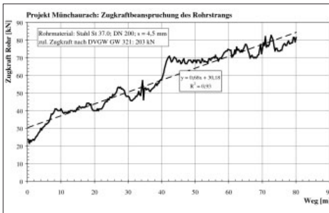
Abb. 14: Zugkraftbeanspruchung des Rohrstranges in Abhängigkeit vom Weg
