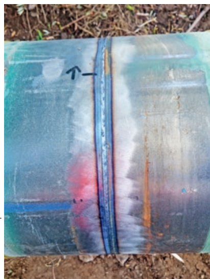
Abb. 1 – Im Feld hergestellte lasergeschweißte Rohrverbindungsnaht – mit deutlich sichtbarer schmaler Naht und Wärmeeintragszone
