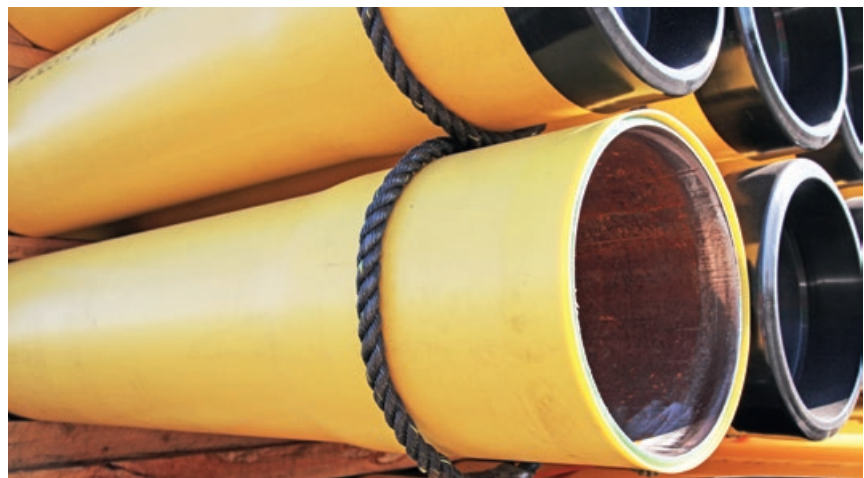
Abb. 4a + b – Aufgeweitetes Muffenende (Bell End) der Zap-Lok-Verbindung vor (oben) und nach (unten) der Beschichtung
