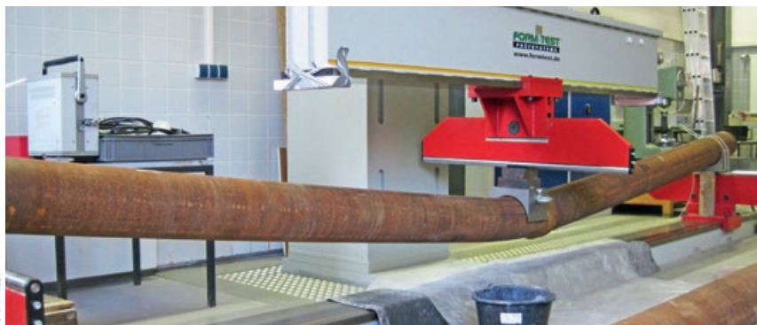
Abb. 8 – Biegeversuche im Testportal der Firma FORM+TEST
