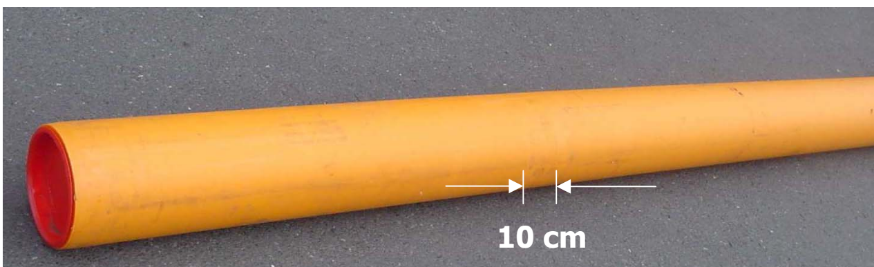
Abb. 3: Proberohr, PE 100, DN 200, SDR 11, Lagerungsdauer im Außenlager 1,5 Jahre
