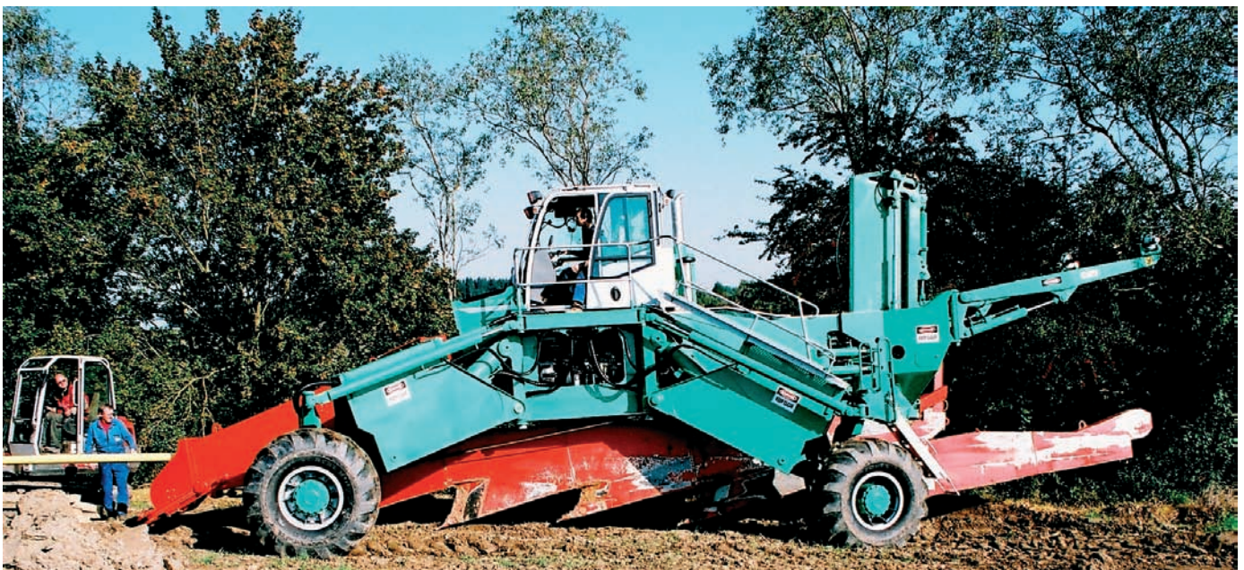
Bild 1: Verlegepflug mit Spezialpflugschwert und eingeführtem Rohrstrang vor dem Absenken des 16 m langen Schwertes
