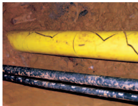
Bild 3: Sprödbrech an einer extrudierten Polyethylenumhüllung Fig. 3: Brittle fracture in an extruded polyethylene coating
