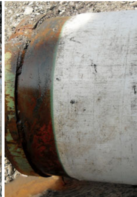
Abb. 8 und 9 FZM-Ummantelung und PP-Ummantelung in der Zielgrube
