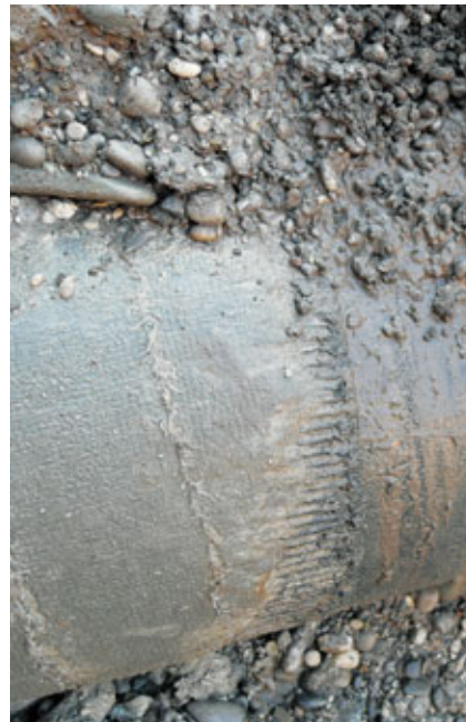
Abb. 8 und 9 FZM-Ummantelung und PP-Ummantelung in der Zielgrube
