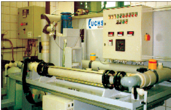
Bild 5: Versuchstand zur Untersuchung der Wechselwirkungen von Zementmörtelauskleidung und Trinkwasser [11]
