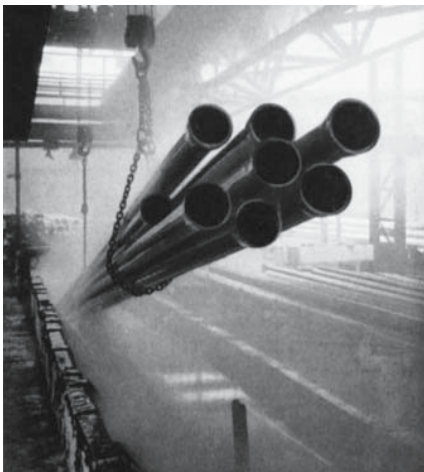
Bild 9. Tauchen von Stahlrohren in ein Bitumenbad.
