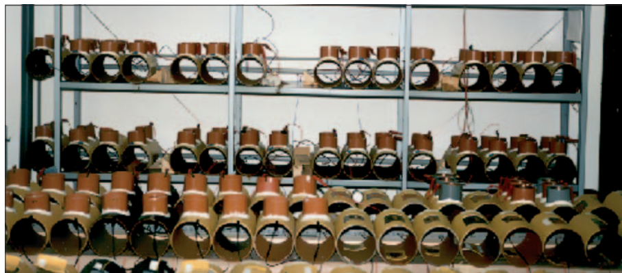
Bild 7: Versuchsstand zur Untersuchung der Rissbildung von Polyethylenumhüllungen Fig. 7: Test stand for examining cracks in polyethylene coatings
