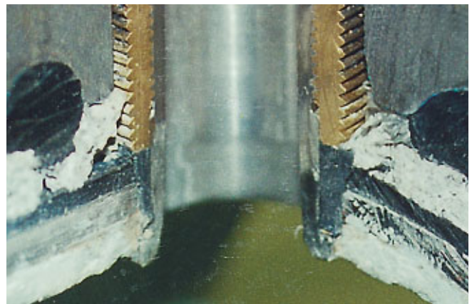
Abb. 3: Dichtungshülse der Anbohrarmatur
