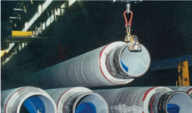
Abb. 7: FZM-Umhüllungen mit der Sonderschichtdicke von 50 mm
