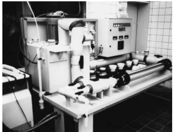
Abb. 2: Versuchsstand zur Untersuchung der Wechselwirkung von Zementmörtelauskleidung und Trinkwasser.
