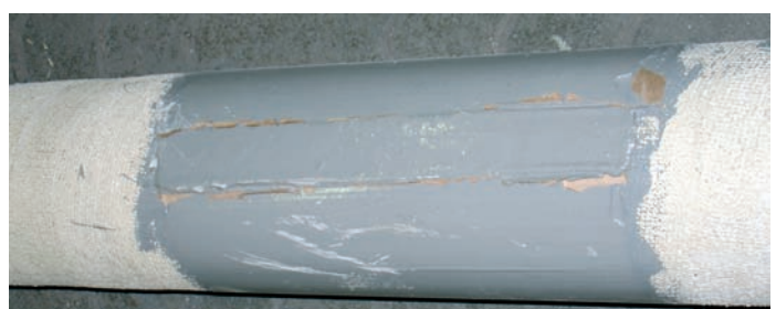
Bild 5: Kombination von FZM-Ummantelung und PUR-Gießharzsystem
