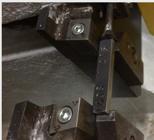
Bild 3 und Bild 4: Ermittlung der Kerbschlagzähigkeit des Rohrmaterials
