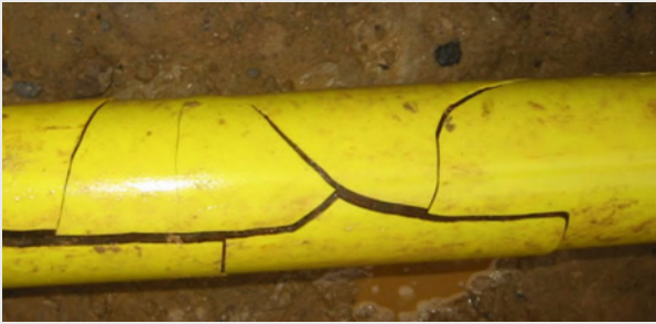
Bild 5 und Bild 6: Rissbildung von PE-Umhüllungen durch Materialversprödung
